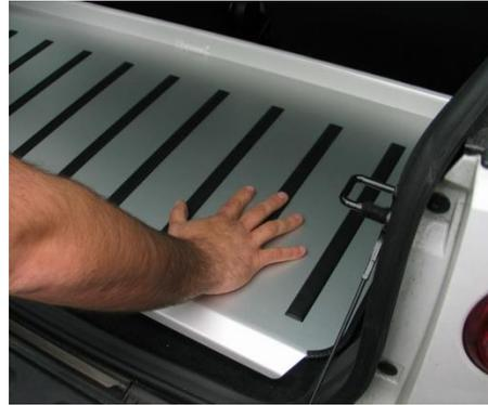
Ladeklappe öffnen; mit Klettunkten ausgestattete Alu-Ladefläche durch die Ladeöffnung führen; Alu-Ladefläche an der seitlichen Kante des Kofferraums ausrichten, absenken und passend positionieren; Klettverbindung durch leichtes Andrücken herstellen.
