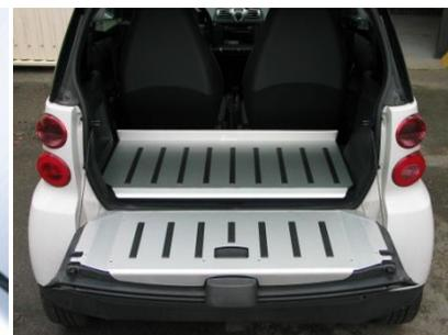
Ladeklappe öffnen; Staufach unter der Heckklappe leeren; Alu-Heckklappenschutz passgenau auf den geschlossenen Kunststoff-Deckel auflegen und zentrieren; manuell fixieren und die vorgesehenen Befestigungsbohrungen als Schablone zum Durchbohren (Bohrer: 4,2 mm) der Kunststoffklappe nutzen; mit beiliegendem Schrauben und Muttern befestigen.
